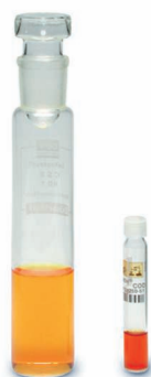
Obr. 4: Kyvetové testy používají až o 90 % méně chemikálií než ekvivalentní titrační metody.
