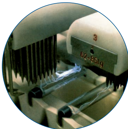
Obr. 2: Komplexní kontrola: Každá kyveta se kontroluje na možné vady skla před tím, než se naplní.
