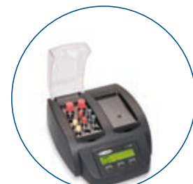
Termoreaktor DRB200 pro teplotní rozklad vzorků odpadních vod před analýzou sumárních parametrů (CHSK, N, P, TOC)
